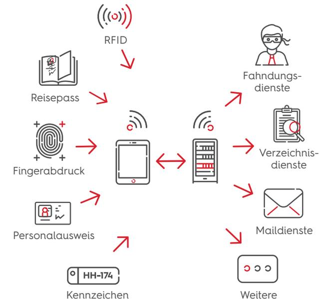
Die Mobile Personenkontrolle besteht aus den Komponenten MPK-App und MPK-Gateway. Die MPK-App nutzt die vorhandenen Sensoren der Hardware zur Datenerfassung aus unterschiedlichen Quellen: der MRZ von Dokumenten, Fingerabdrücken, RFID-Chips usw. Diese Informationen werden über eine verschlüsselte Verbindung an das MPK-Gateway weitergeleitet.
